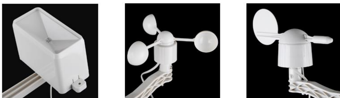
32 pav. Meteorologinių duomenų rinkimui skirti jutikliai: lietaus kiekio, anemometras, vėjarodė
