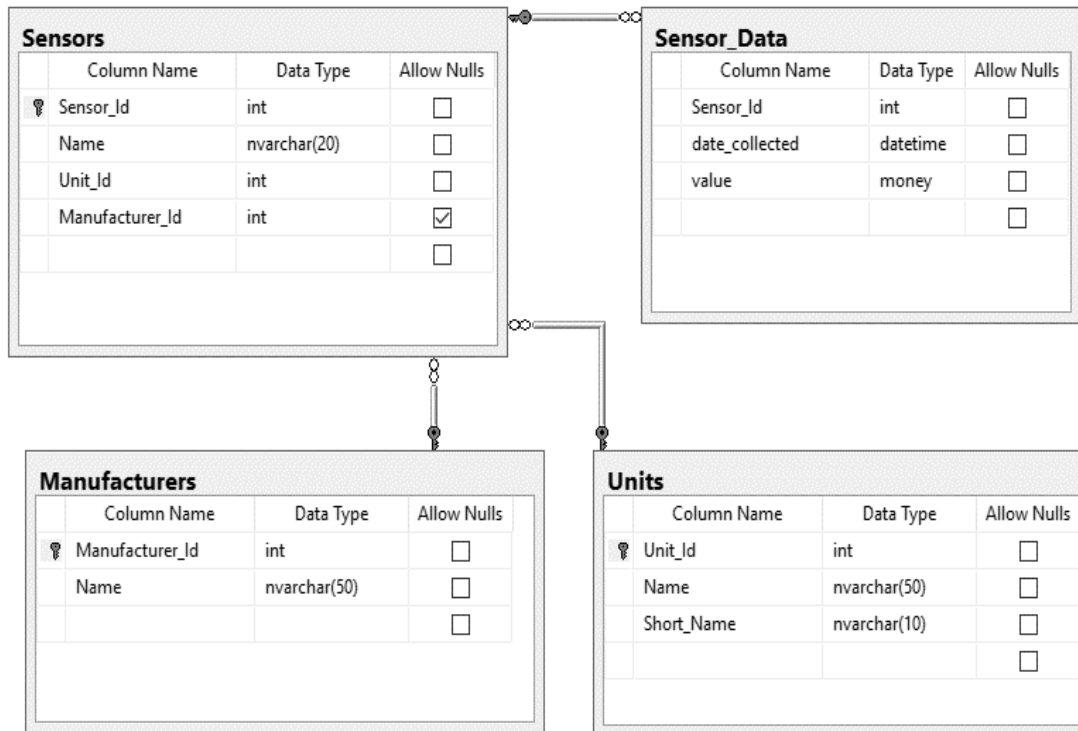
11 pav. Elektros energijos skaitiklių duomenų bazės struktūra jutiklių duomenims rinkti
