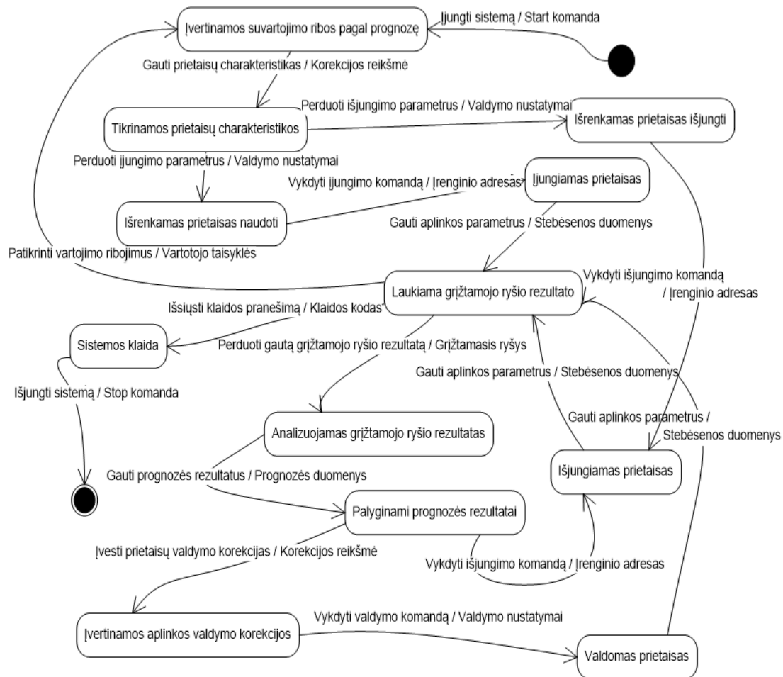
26 pav. El. energijos valdymo sprendimų priėmimo sistemos baigtinių būsenų automatas
